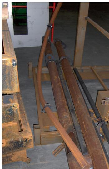
L'état de surface du métal utilisé pour la fabrication d'une pièce joue un rôle fondamental sur l'esthétique et la durabilité du thermolaquage : marques et défauts de performance.
