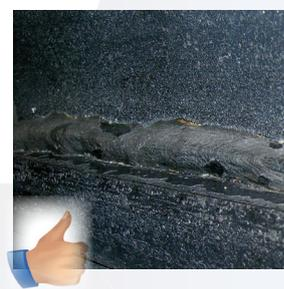
Le laitier et les projections de soudure doivent être éliminés. Les produits destinés à empêcher l'adhérence de projections (anti gratons) doivent être exempts de silicones qui nuiraient à la mise en peinture et une préparation de surface adéquate (chimique ou mécanique) doit être réalisée sur ces anti-adhérents.
